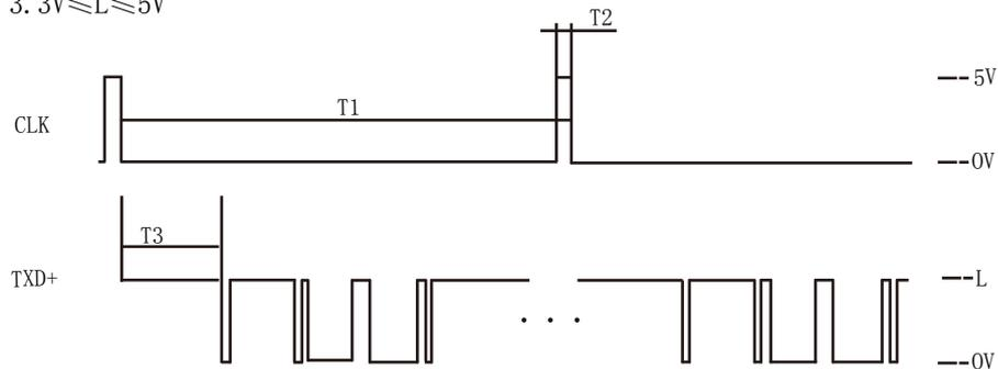
外部脉冲信号下降沿触发编码器工作
