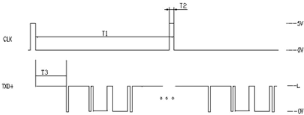
外部脉冲信号下降沿触发编码器工作
