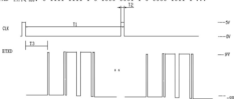
脉冲握手：外部脉冲信号下降沿触发编码器工作
