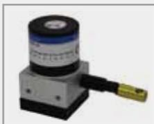
数字信号输出型可以选择增量型编码器或绝对型编码器，输出信号为方波ABZ信号或格雷码信号，测量行程可以做到600mm，线性精度达0.05%FS，精度根据配置不同最大可以达到0.008mm，防护等级最大可以达到IP65，工作温度 $-30\text{ }^{\circ}\text{C}$ — $+90\text{ }^{\circ}\text{C}$ 。
